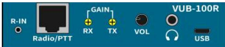
**R-IN** : 电台音源输入接口, 用带 2.5 毫米音频插头的对连线连接到对讲机 2.5 毫米耳机口。
